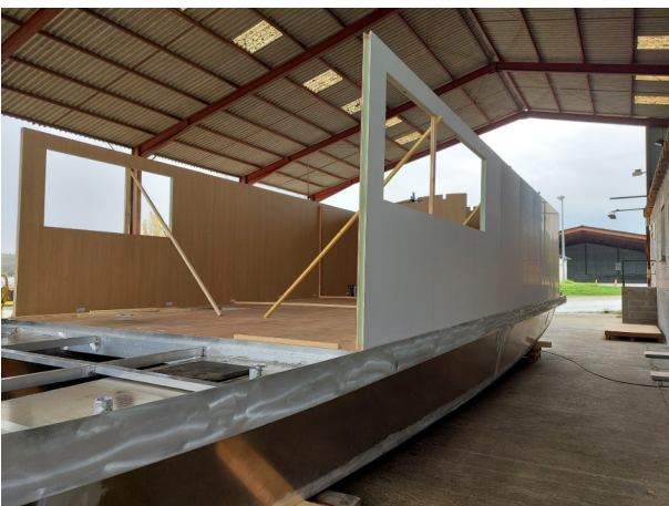
Le « Coche Solaire » Une construction de qualité, éprouvée et un habitat confortable ! La coque est en alu épais (strongal)
