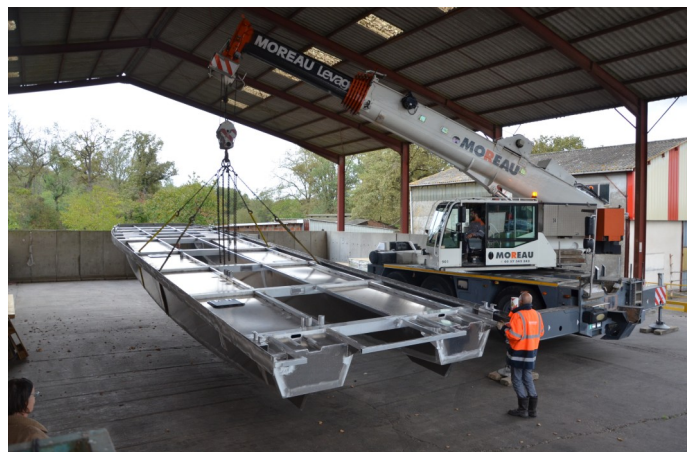
Le « Coche Solaire » Une construction de qualité, éprouvée et un habitat confortable ! La coque est en alu épais (strongal)
